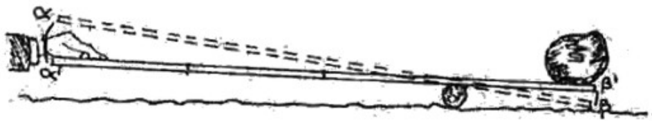
Figura 3. Si el brazo izquierdo de la palanca es tres veces más largo que el derecho, el movimiento del extremo izquierdo ( \alpha\alpha' ) es tres veces mayor que el movimiento del brazo derecho ( \beta\beta' ).
